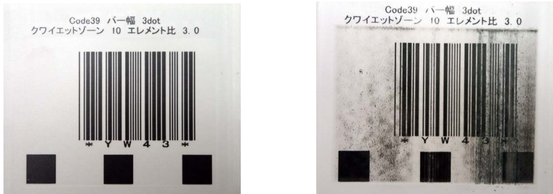
初回 2000 回リライト 図 3 1 次元シンボル (コード 39) の印字変化 (JAISA 報告書より抜粋)
